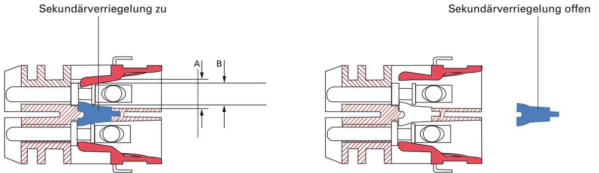
1. Werkzeug von hinten in die Kammer einführen
