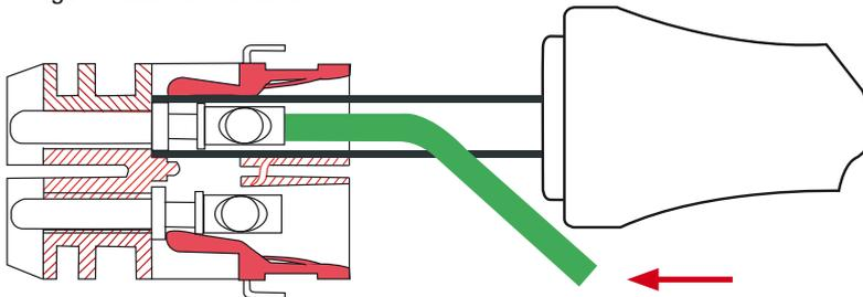
3. Werkzeug mit niedergedrücktem Kabel aus der Kammer ziehen
