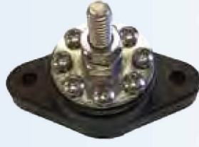
AP.075 1 8 polig 160 Amp - 12V 8-weg aansluiting. Kleur zwart M8 bout in het midden + 8 M4 schroeven voor andere aansluitingen. Dim: H53.8xW45.4xD85.0
