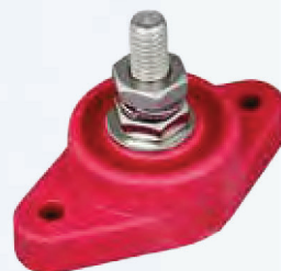
AP.072 1 1 polig 240 Amp - 12V 1 weg verdeelpunt met M10 bout. kleur rood - eenvoudig montage voorgeboorde gaten in de voet. Dim: H54.4xW44.5xD83.8
