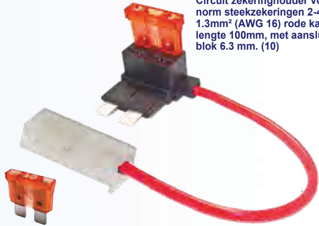
FU.974 Circuit zekeringhouder voor norm steekzekeringen 2-40A 1.3mm 2 (AWG 16) rode kabel, lengte 100mm, met blauwe doorverbinder. (10)
