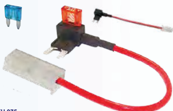
FU.975 Circuit zekeringhouder voor 2 mini steekzekeringen 2-30A 1.3mm 2 (AWG 16) rode kabel, lengte 100mm, met aansluit blok 6.3 mm. (10)
